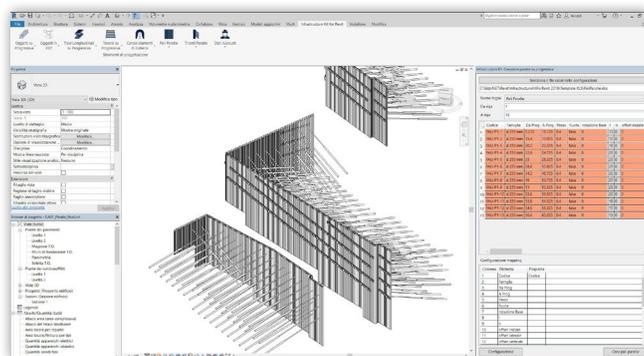
Creare famiglie di oggetti con Infrastructure Kit for Revit permette di conseguire un ulteriore vantaggio in termini di aumento della competitività aziendale: il progetto infrastrutturale è arricchito con oggetti BIM, ossia elementi strutturali definiti da precisi parametri e proprietà, che gli conferiscono una qualità superiore in fase di valutazione da parte della committenza.
